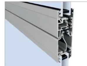
Das NovoLux 40 Clima ist mit thermisch getrennten Aluprofilen ausgestattet, die mit einem Isolator aus Kunststoff versehen sind. Die Dichtungen zwischen den Sektionen sind für hohe Leistungswerte ausgelegt.
