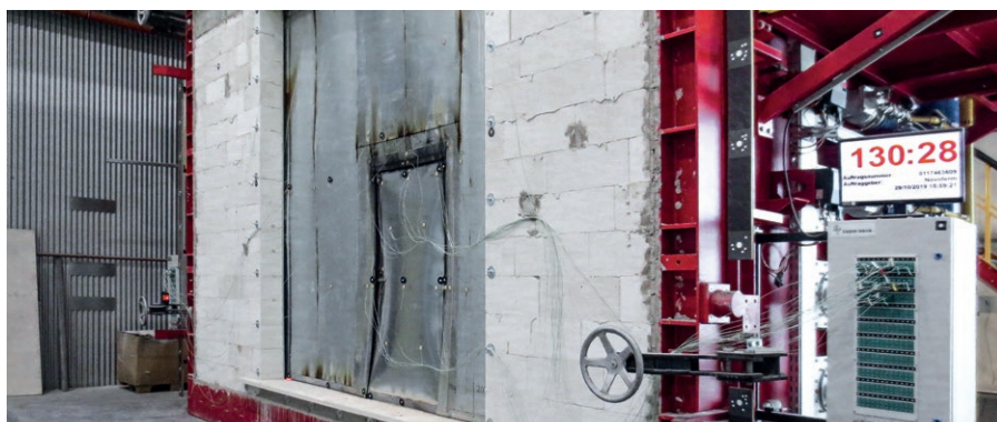
Brandprüfung Toransicht nach 130 Minuten
